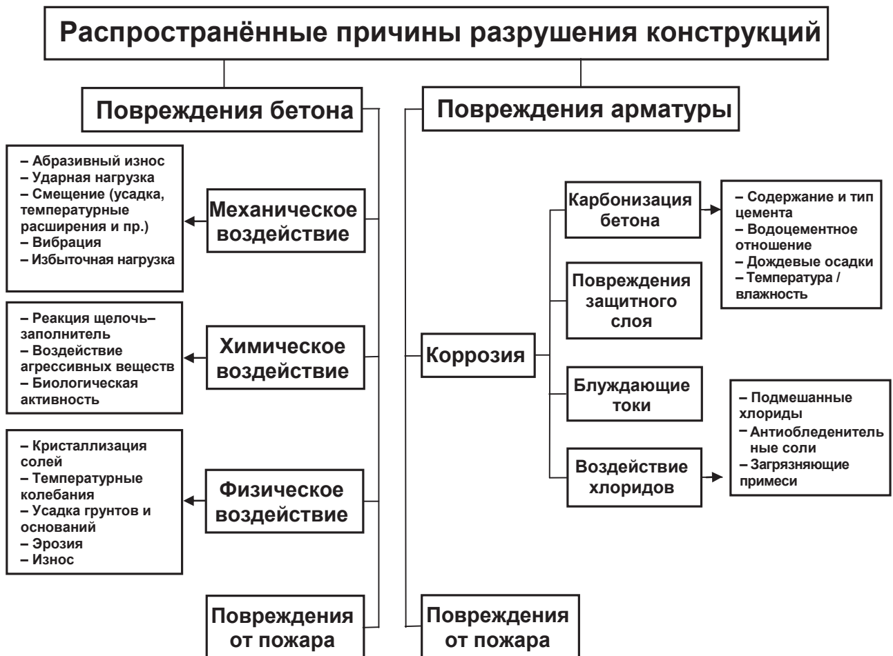
Рисунок 5.2 – Распространённые причины разрушений конструкций
