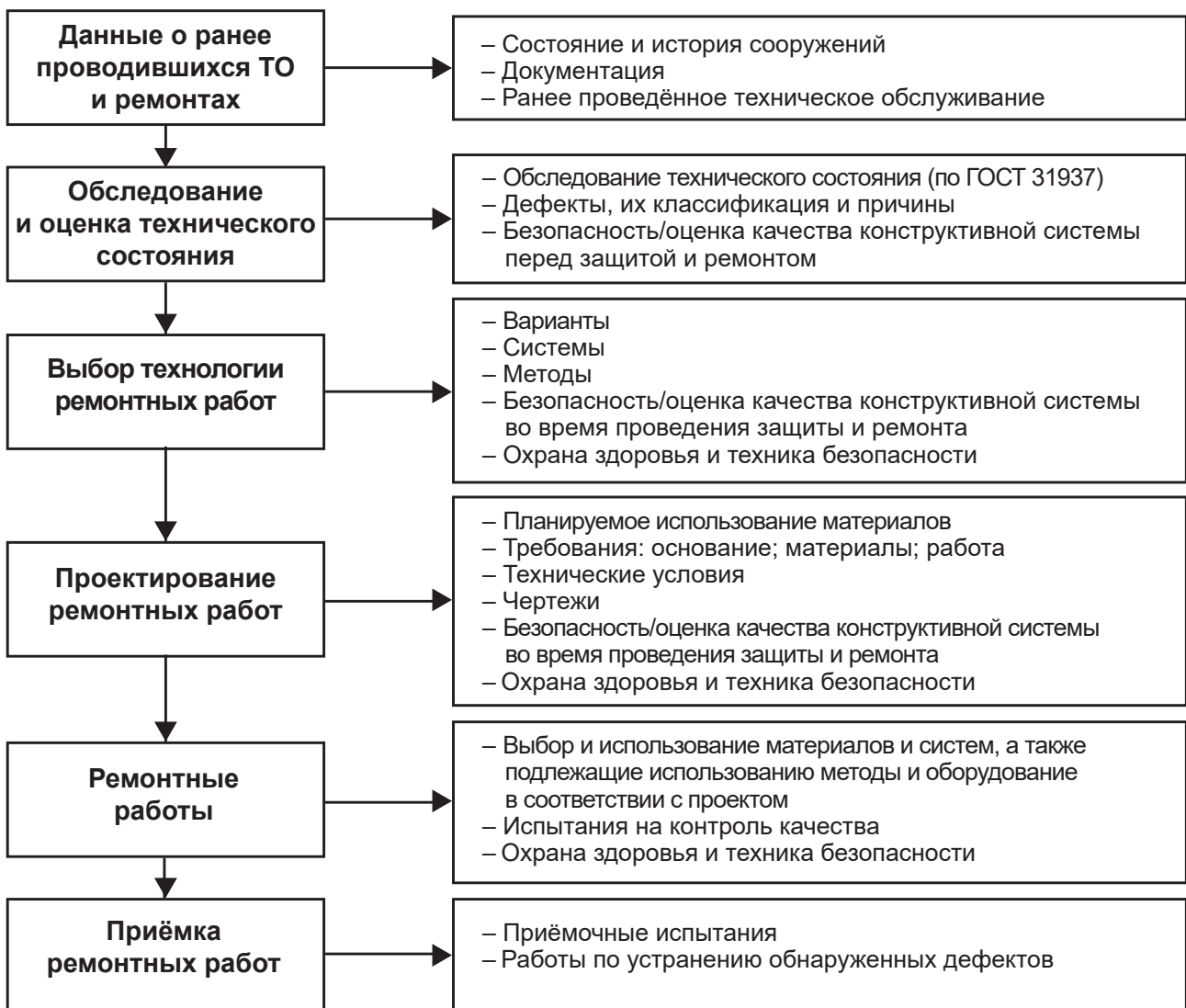
Рисунок 5.1 – Этапы стандартного проекта по ремонту
